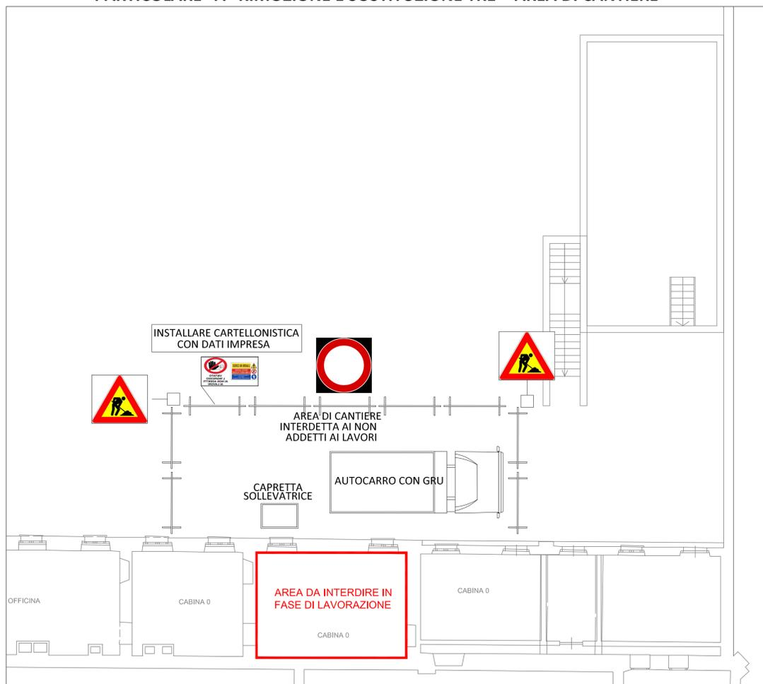
**PARTICOLARE "B" RIMOZIONE E SOSTITUZIONE QE CENTRALE FRIGO - AREA DI CANTIERE**
