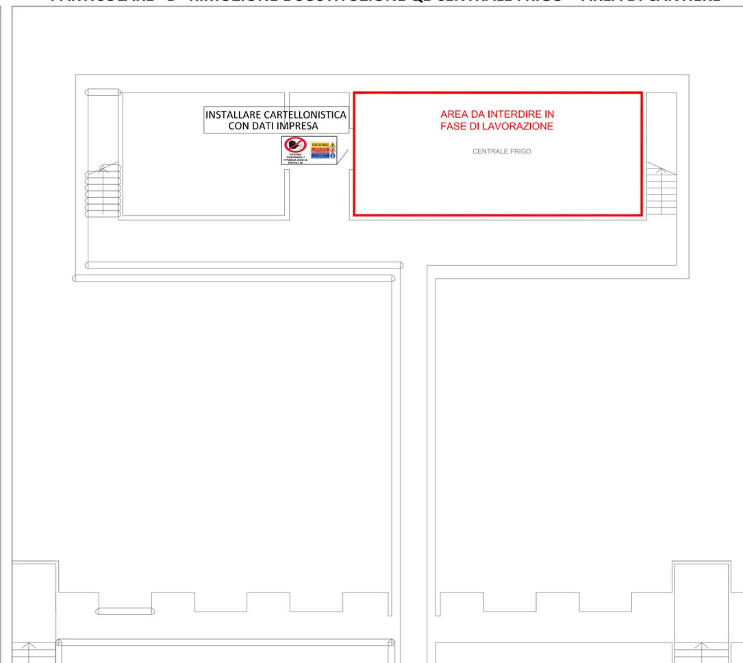
**PARTICOLARE "C" RIMOZIONE E SOSTITUZIONE QE CENTRALE TERMICA - AREA DI CANTIERE**
